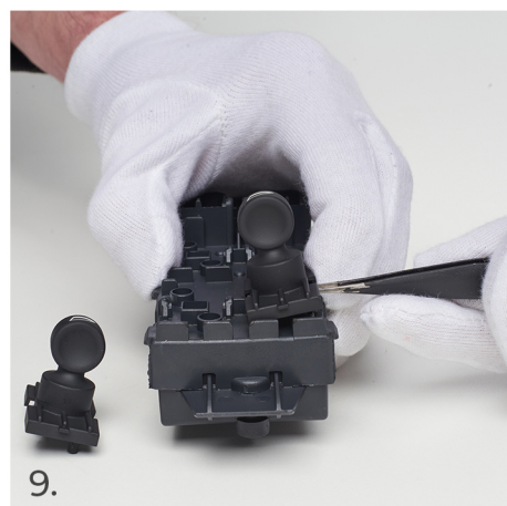
9. Jemně vypáčte spínač pomocí špičky pinzety a pokračujte stejně jako u předešlého spínače.
