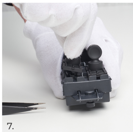
7. Uchopte spínač a jemně přitáhněte k sobě, abyste jej uvolnili ze zařízení.
