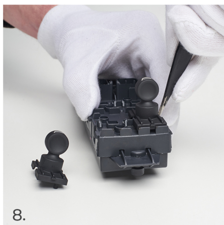
8. Opět začněte z vnější strany spínače.
