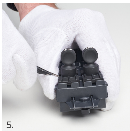
5. Jemně vypáčte spínač pomocí špičky pinzety.
