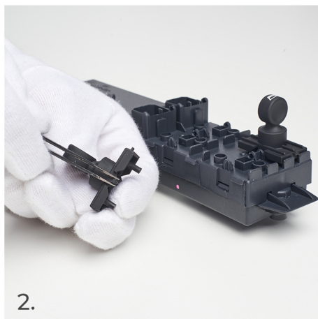
2. Tady je místo, kam musíte umístit špičku pinzety, abyste předešli poškození spínače nebo zařízení.
