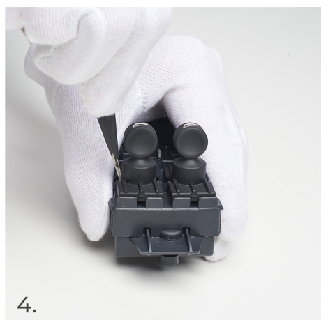
4. Jemně vypáčte spínač pomocí špičky pinzety.
