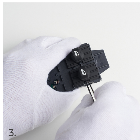
3. Vždy začněte z vnější strany spínače. Začněte shora a umístěte špičku pinzety do místa zobrazeného na předchozím obrázku.
